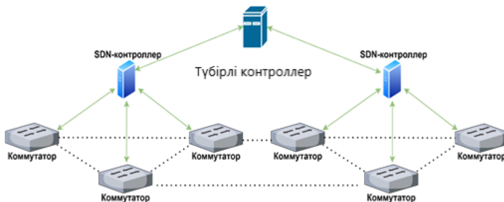
2.4-сурет – SDN иерархиялық көпконтроллерлік желі
